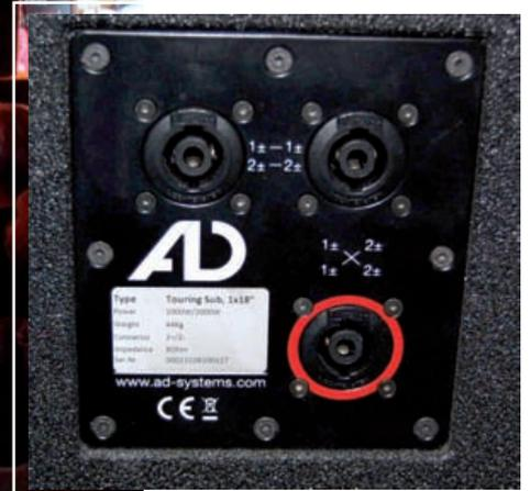
**Bild 4:** Die Anschlussplatte des „Touring Sub“ mit der Signalweiterleitung zum Topteil
