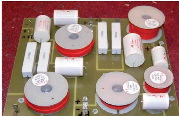
Bild 1: Die aufwendige Frequenzweiche für den passiven Betrieb der „STiUM“ ist als 2,5-Wege-Weiche mit hochwertigen Bauteilen bestückt
