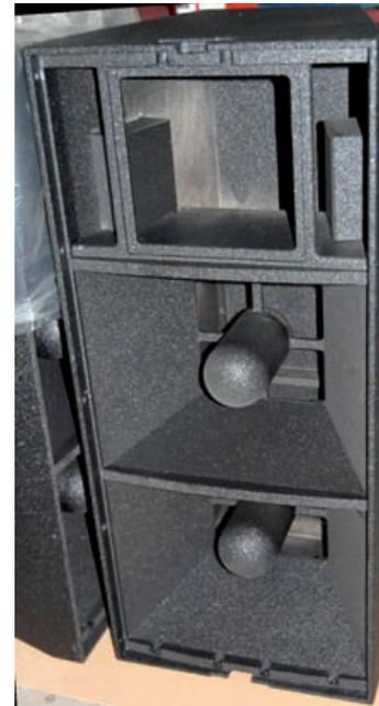
Bild 2: Ein fertiges Rohgehäuse der „STiUM“ kurz vor der Fertigstellung
